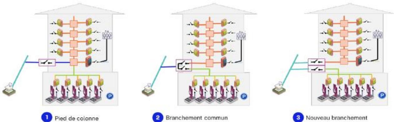
**En respectant l'offre de raccordement de référence, il est privilégié de raccorder l'infrastructure collective de manière à réutiliser un tronçon commun (en bleu dans les schémas).** Ainsi, on raccordera en premier lieu par le pied de colonne (1). Si cela n'est pas réalisable, il peut être envisagé de le réaliser par un branchement commun (2). Enfin et en dernier lieu, le raccordement pourra se faire par un nouveau branchement (3). L'ordre de priorité pour le raccordement est donc :
