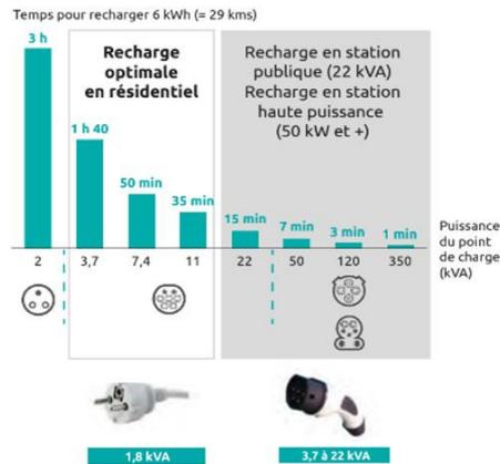
Figure 1 : Temps de recharge pour 6kWh selon le type d'IRVE
